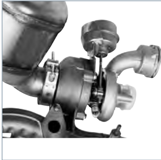
Automobil: Verbindung Turbolader – Katalysator
