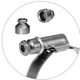
A tampa dinamométrica para quando o binário de aperto permitido é alcançado, o que significa que não é necessário utilizar uma chave dinamométrica. Continua a ser possível aceder à ranhura do parafuso mesmo após o ponto de rutura, o que significa que a abraçadeira pode ser removida e/ou novamente tensionada, se necessário.
