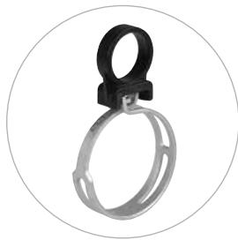
Uma versão pré-aberta que é fixa por um clipe de plástico. Após a abraçadeira ter sido empurrada para o tubo flexível, este clipe pode ser libertado facilmente à mão.
