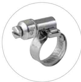
A abraçadeira para tubos de gás NORMA CLAMP® TORRO® foi concebida para fixar tubos flexíveis para gás propano e doméstico. O parafuso desta abraçadeira parte-se quando é atingido um nível de binário previamente determinado para cumprir rigorosamente os valores da norma. A rutura ocorre a um binário de 1,2 Nm.
