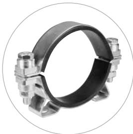
Nesta versão, as extremidades do suporte são dobradas para trás e soldadas por pontos na fita. Graças à respetiva estrutura, a NORMA CLAMP® HMK de duas peças é adequada para utilização com cargas mecânicas elevadas uniformes e para fixação de conectores e tubos rígidos extremamente pesados.
