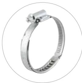
A abraçadeira de mola Radial® é composta por uma abraçadeira rebatida padrão com um revestimento em aço inoxidável. Esta inserção na Radial atua como uma mola. A pressão radial interna no tubo flexível é possível, pois o material entre os entalhes e o encaixe longitudinal atua como um feixe de molas.
