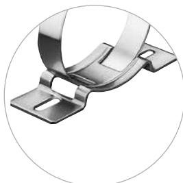
Estes são suportes pré-fabricados que pode utilizar para transformar rapidamente as abraçadeiras NORMA CLAMP® padrão (tipos GBS, HD, SP e TORRO) em abraçadeiras de retenção com suporte. Basta abrir a abraçadeira padrão, encaminhar a fita através da ranhura do suporte e fica pronta.
