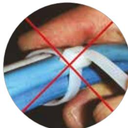
**3** Evite dobrar acentuadamente a abraçadeira. Esta ação não melhora a força de fixação.
